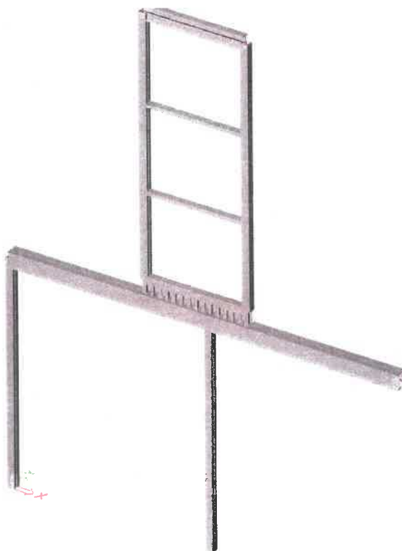
Obr. 1 Výpočtové schéma podpůrné ocelové konstrukce
