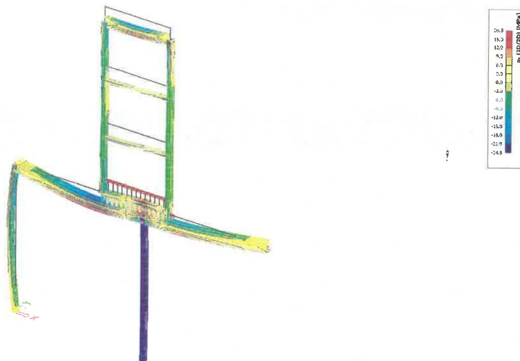
Obr. 4 Velikost napětí na ocelovém rámu a tvar deformace
